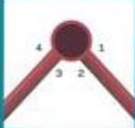
**Finiture.** Tavoli con 4 saldature per gamba. I banchi e i tavoli realizzati con 4 montanti sono collegati al tubo perimetrale con quattro saldature per ciascun montante realizzate a filo continuo. Ciò garantisce il massimo della resistenza del banco anche con forti pressioni laterali e angolari su una sola gamba.
